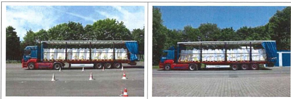
Die am 25. Mai 2012 durchgeführten Fahrversuche zu diesem Gutachten, haben ergeben, dass bei formschlüssiger Verladung zur Stirnwand und der Bigbag untereinander und entsprechenden Kopflashings die nach
